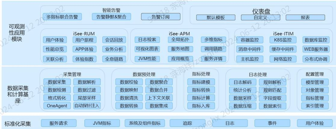
图 4-1 DevOps 可观测平台功能架构
